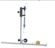
E' costituito da una rotaia sulla quale può scorrere un carrello a basso attrito. Mettendo in rotazione l'apparecchio è possibile leggere sul dinamometro il valore della forza centrifuga, ed è possibile verificare la formula della forza centrifuga.
