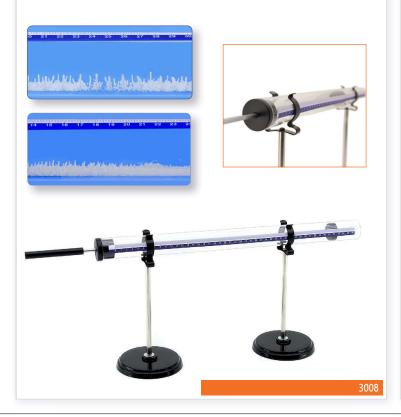
Strumento per misurare la velocità delle onde acustiche nell'aria
