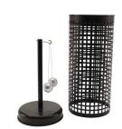
Viene fornita con doppio pendolino elettrico, consentendo così di eseguire esperienze sulla schermatura elettrostatica.
