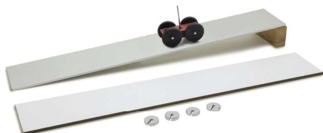
Lungo il piano inclinato di laminato plastico il moto del carrello è uniformemente accelerato; lungo il piano inclinato di alluminio il moto è uniforme, a causa del freno elettromagnetico.
