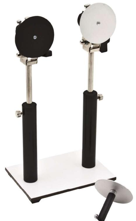
Due dischi di alluminio identici, uno dipinto di nero e l'altro lucido, sono esposti alla luce di una lampada da 100 W. Un sensore di temperatura posto su di essi dimostra che il coefficiente di assorbimento del disco nero (linea verde) è maggiore di quello del disco lucido (linea rossa).
