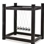
E' costituito da cinque sfere di acciaio tutte della stessa massa, allineate ed a contatto l'una con l'altra. Sollevando la prima e rilasciandola la sua quantità di moto e la sua energia vengono trasmesse all'ultima sfera. Il fenomeno non ha luogo se fra due sfere viene interposto un dischetto di materiale deformabile.
