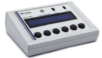
Per il corretto funzionamento sono necessarie due fotocellule codice 5453 e un elettromagnete codice 5454. Alimentatore incluso.
