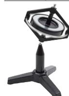
Ruota giroscopica in metallo. Mettendola in rapida rotazione per mezzo di una cordicella, si può verificare la conservazione del momento angolare. Se si applica una forza perpendicolare all'asse di rotazione, è possibile osservare il fenomeno della precessione, ovvero l'effetto giroscopico.
